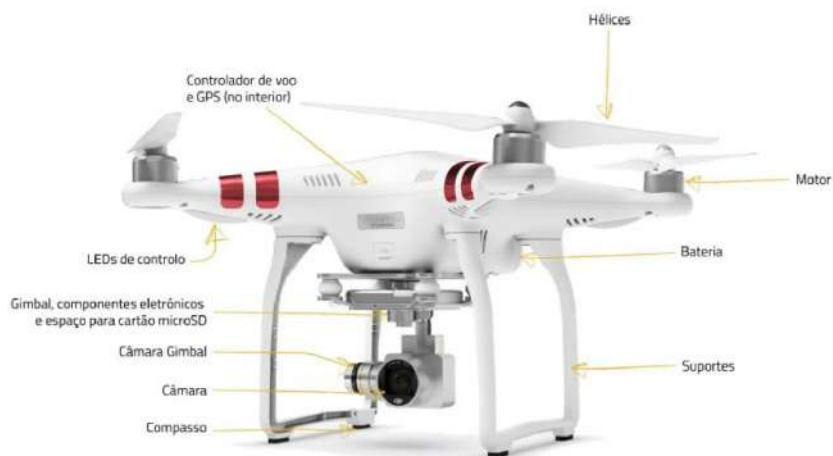
Figura 1. Ilustração dos componentes principais de um drone para monitorização das culturas
