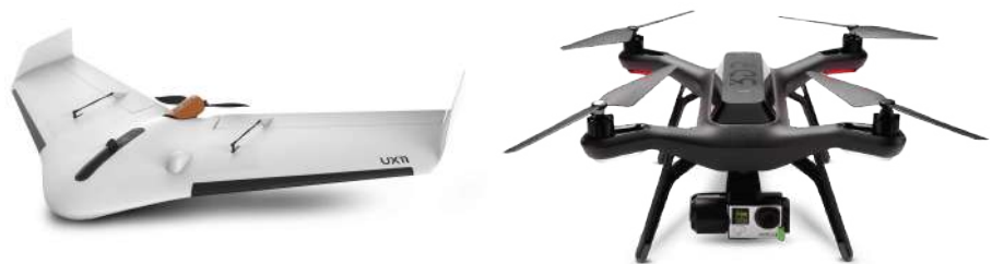
Figura 1. Drone de asa fixa (à esquerda) e de asa rotativa (à direita)
